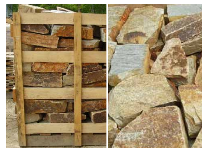
MU 014 Moellon brut de gneiss, maçonnerie
